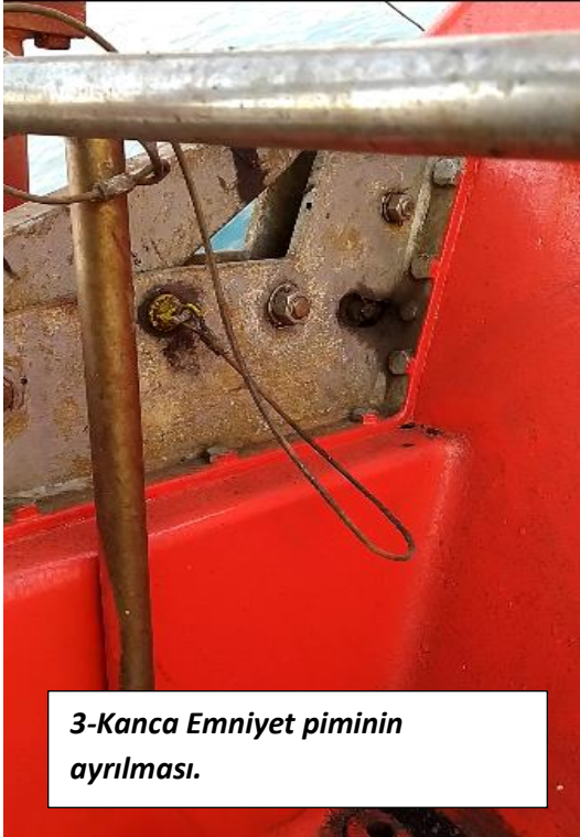
Resim 6 Kapalı Can Filikasının Denize İndirilme Adımları
